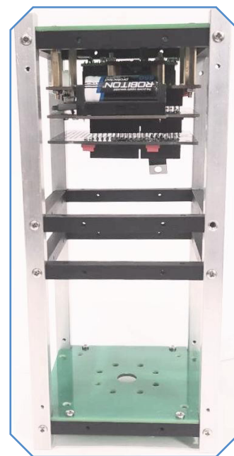
РИС. 48. КОРПУС СПУТНИКА CUBESAT 2U С УСТАНОВЛЕННЫМИ ПЛАТАМИ УПРАВЛЕНИЯ
